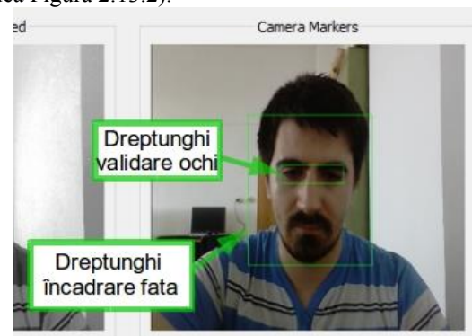
Fig. 2.13.3. Exemplu de patrulater valid - dreptunghi validare ochi și dreptunghi încadrare față.
