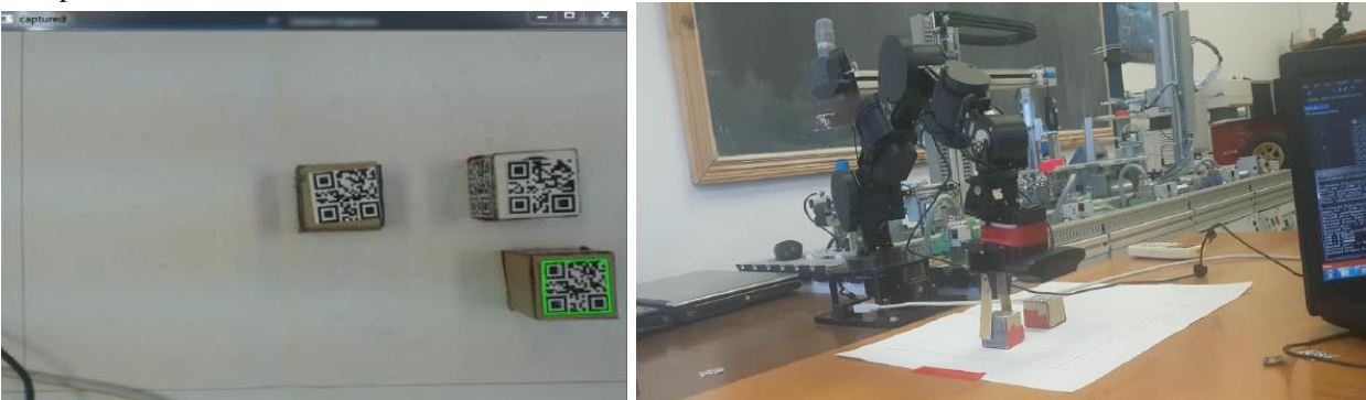
Fig. 2.15.5 Scanarea diverselor coduri QR și găsirea/detectarea codului cerut de utilizator.
